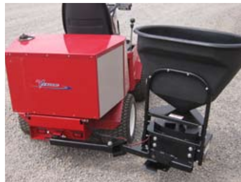
Monteringsfästet på 3000-serien kan svängas ut för att ge åtkomst till motorn.
